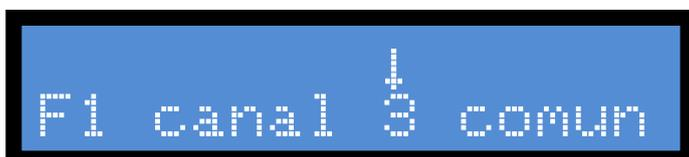
Quando o cursor está sobre "**comun**" todos os marcadores que se encontrem ao alcance do sinal de radio, e não estejam funcionado com a sua própria consola, funcionaram de forma conjunta com esta consola. Quando a consola funciona neste canal os marcadores que se encontram ao alcance do sinal de radio embora estejam funcionando com a sua própria consola, podem sofrer interferências e começarem a funcionar em conjunto.
